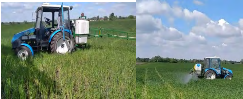
Рис. Зразок робота обприскувача, створеного в ІМА АПВ НААН на базі електротрактора ХТ3-2511Е
