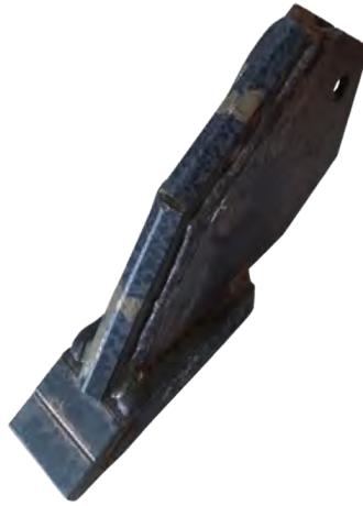
Рис. Долотовидний сошник агрегату StripCat II з 2-ма припаяними пластинами на носку
